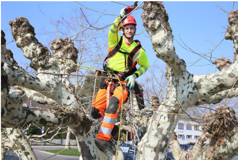
Le système d'assurage de la position de travail (baudrier avec ceinture et longues de maintien en position de travail) permet de libérer les deux mains pour travailler tout en restant sécurisé.
