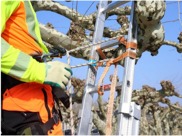
Sécurisation sur une échelle: à travers l'échelle
